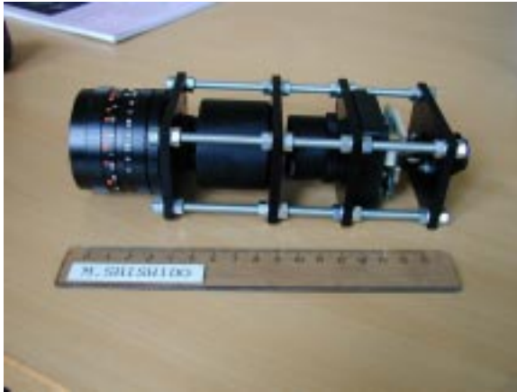
Selbstgebaute Videokamera mit nachgeschaltetem Bildverstärker.
