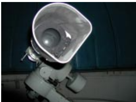
Bild oben: Das Objektiv des Coudé mit Blende und dem Verschuß. Beide lassen sich fernbedienen.
